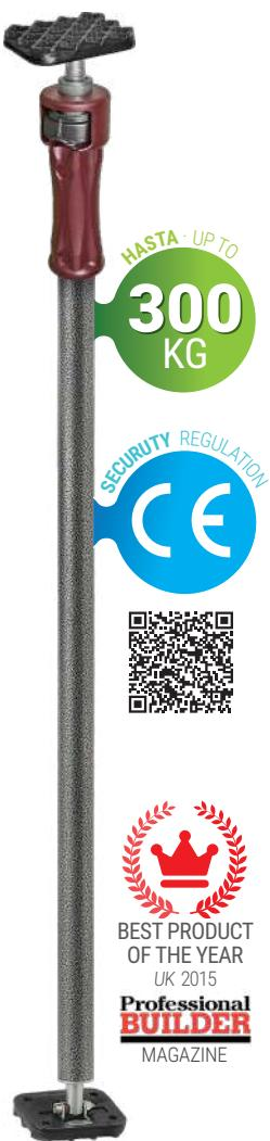
Las cargas aconsejadas son el resultado de aplicar un coeficiente de seguridad de 1,5 a la carga testada. Por ejemplo, si la carga aconsejada es de 300Kg en el test hemos aplicado 450Kg y la herramienta no ha sufrido ningún deterioro.\*
